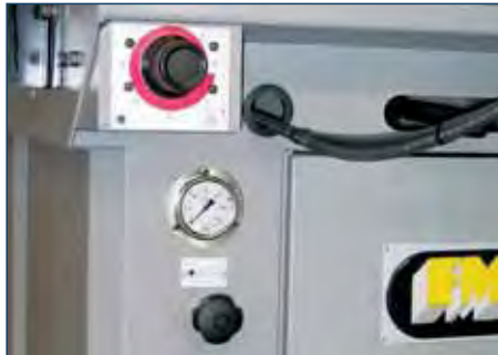
REGOLAZIONE PRESSIONE MORSA VICE PRESSURE ADJUSTMENT REGLAGE DE LA PRESSION DE SERRAGE DE L'ETAU HUBBEGRENZUNG SPANNSTOCK REGULACION PRESIÓN MORDAZA
