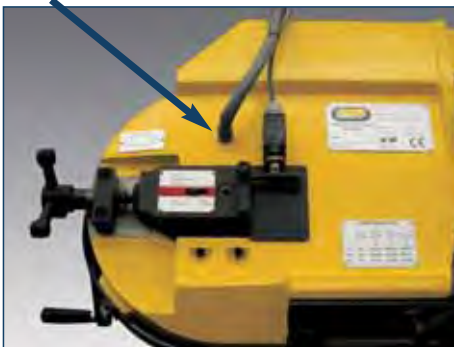
SENSORE ROTAZIONE NASTRO BLADE ROTATION SENSOR CONTRÔLE DE DEFILEMENT DU RUBAN PAR DETECTEUR DREHZAHL-UEBERWACHUNG CONTROL ROTURA DE LA HOJA
